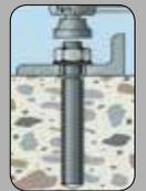
Posizionare l'elemento da fissare e serrare con chiave dinamometrica.
