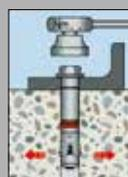
4. Avvitare mediante chiave dinamometrica applicando la coppia di serraggio prescritta.
